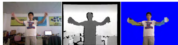
图 9 深度图和彩色图像没有对齐导致的失败结果
