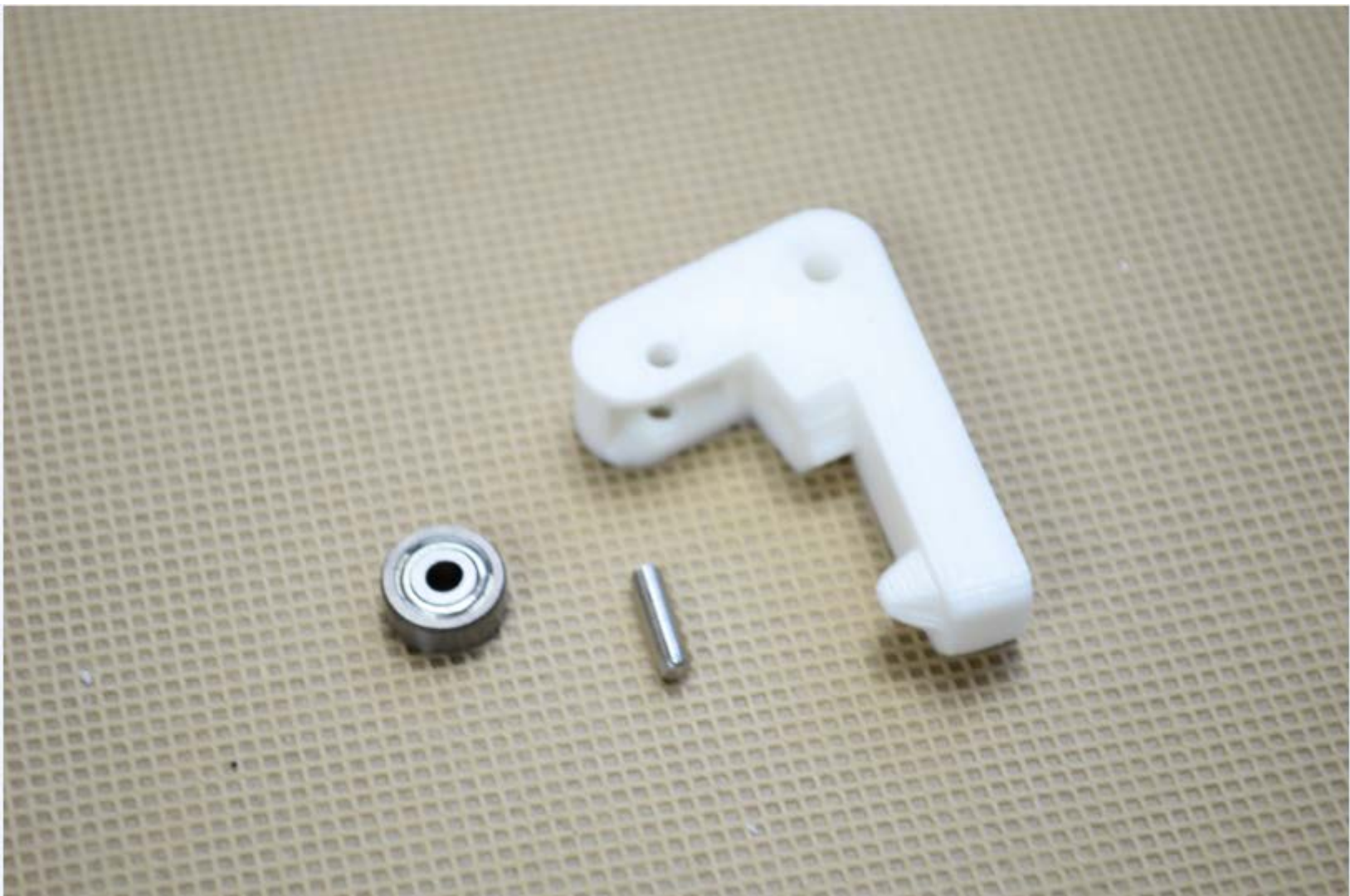
用 M3-10 顶丝安装 623zz 轴承到 mk8_A 中。如图：
