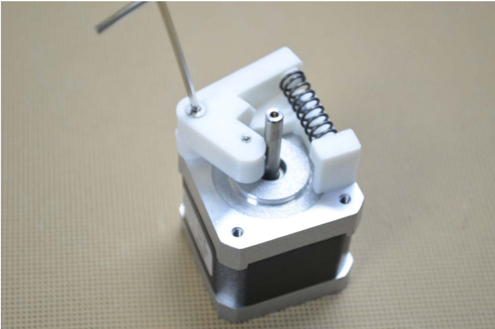
固定 mk8_A 到步进电机上。如图：
