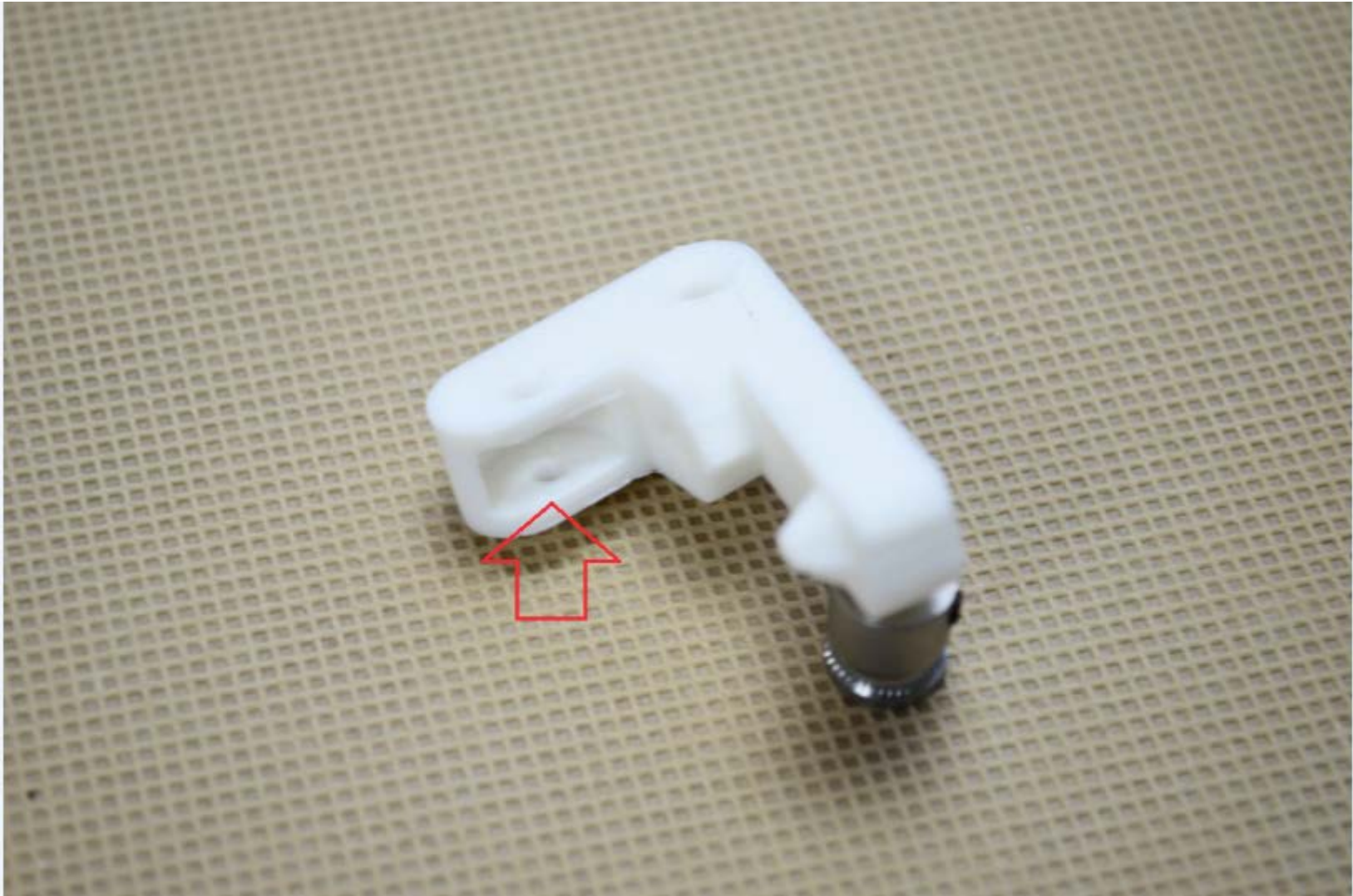
用 M3-10 顶丝安装 623zz 轴承到 mk8_A 中。如图：
